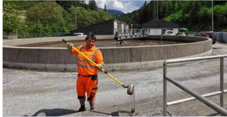
Klärwärter Reinhart Pehringer bei der täglichen Probenahme des Abwassers, das neben vielen Umweltparametern auch auf das Vorhandensein von Corona untersucht wird.
